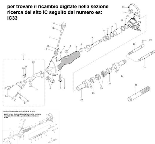
RICAMBIO HEINIG ICON BOCCOLA DI PRESSIONE FIG. IC12
